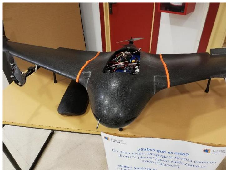
*Dron-avión diseñado en la EUPT*
